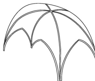
f: Krydsribbehvælv med mellemribber
